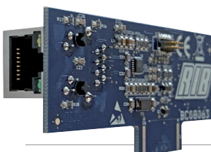
APP8066 Module RJ45 pour Carte APP+ pour gérer le tableau de contrôle via un réseau de données local (LAN)
